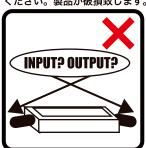
取り付け時にケースが歪むような 場所での設置は避けてださい。
