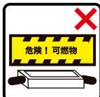
★電源自体も発熱致しますので 製品の放熱を妨げるような設置は避けてください。
